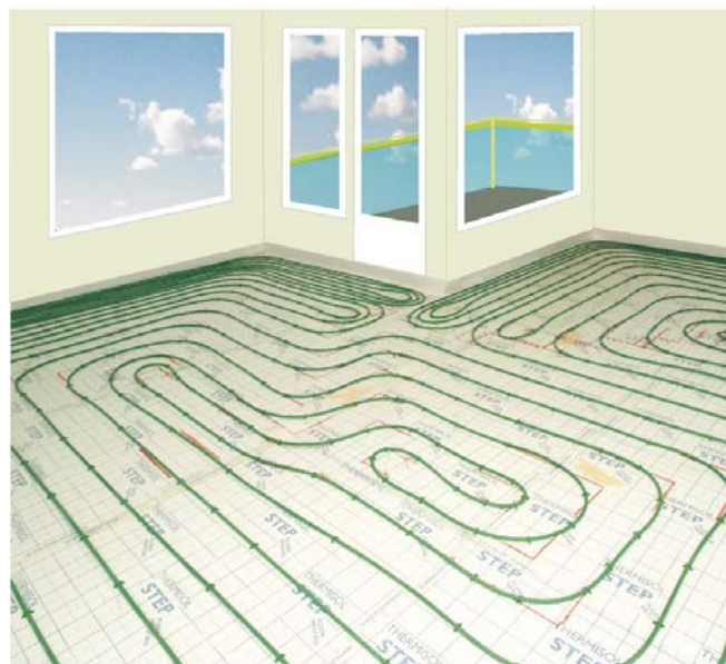
Lattiarakenteeseen on helppo yhdistää sähkö- tai vesikiertoinen lattialämmitys.
